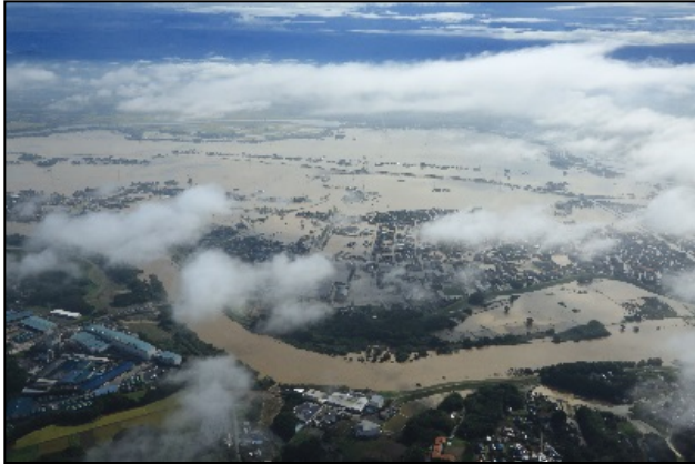
測量用航空機くにかぜ撮影の空中写真から推定浸水範囲を判読して地図化
