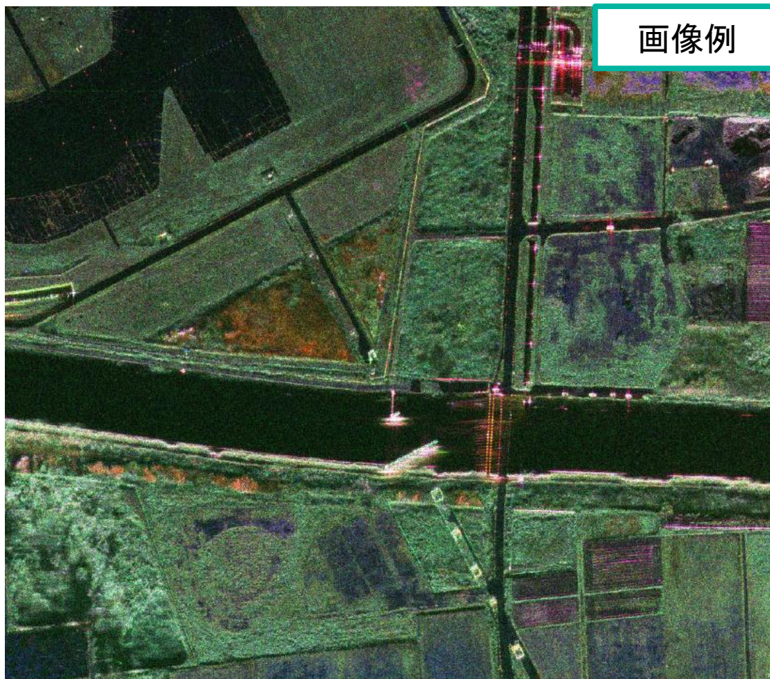
研究開発中の航空機搭載SARで取得したSAR画像 (2014年9月観測・仙台空港近辺: R(HH), G(HV), B(VV))
