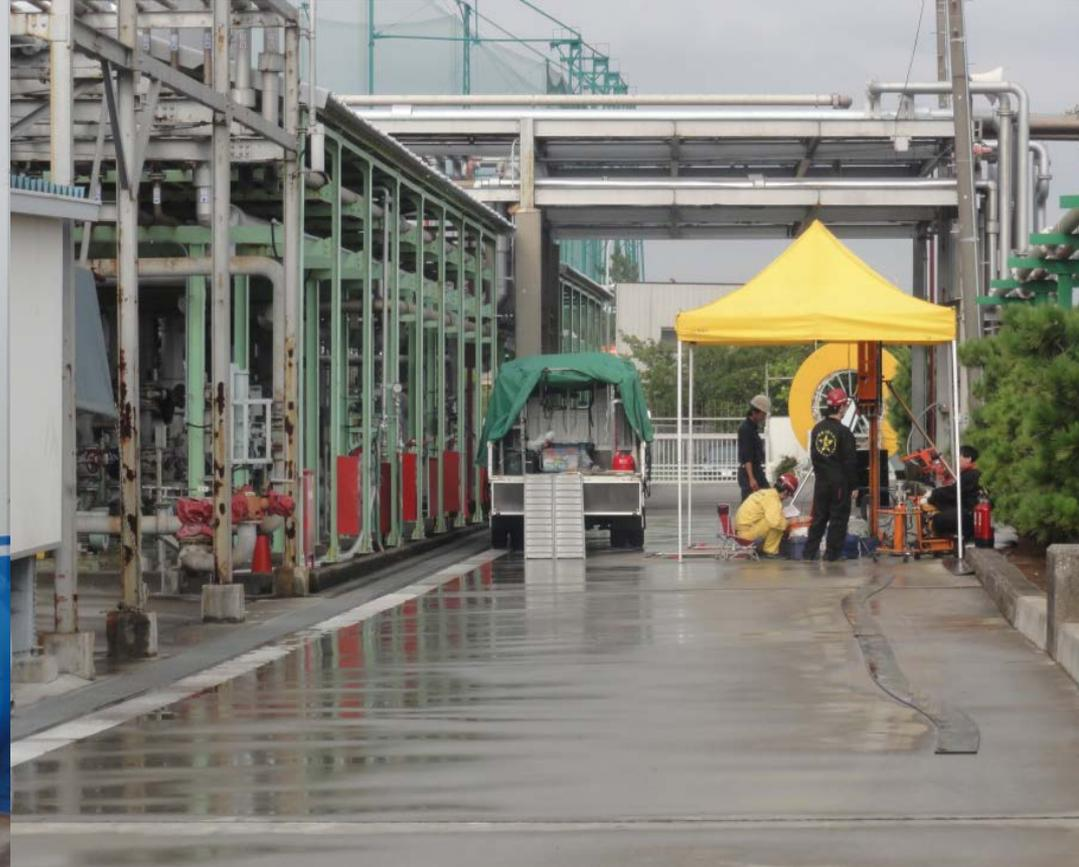
直径36mmの金属コーン(先端に水圧センサーを装備)を打撃しながら地中に貫入していく
