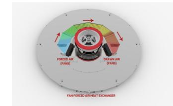
図2 熱交換システム設計略図
