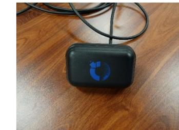
図3 バックアップ通信用トランシーバ
